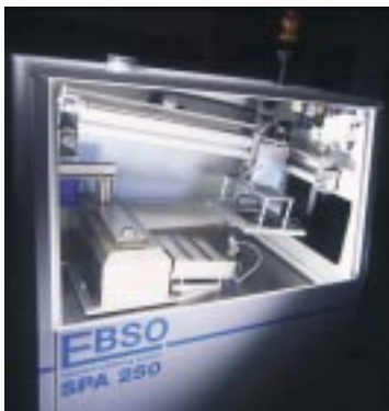
Mit dem Selektiv-Lötssystem SPA 250 lassen sich auch bleifreie Lotlegierungen problemlos verarbeiten
